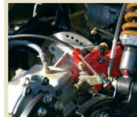
Effektiv und geschützt: Scheibenbremse auf der Antriebswelle.
