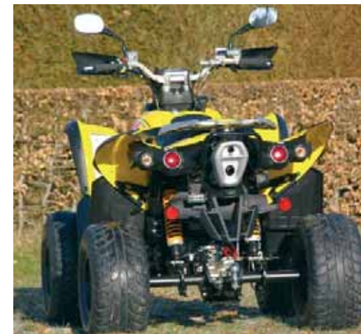
Hecksichten: Kardanantrieb und zwei Federbeine.
