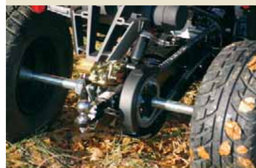
Sekundärtrieb: Klassisch mit Kette.
